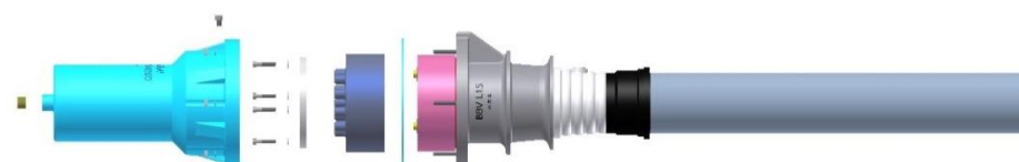
Aufbau eines Spannankers mit Mehrflächenanker, Typ E
